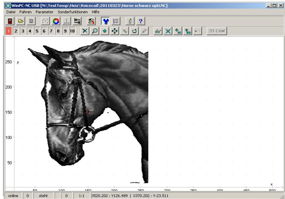
Schattierung abhängig von Drehzahl für Schleifanwendung
