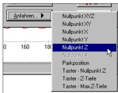
Das Anfahren von gespeicherten Hilfspunkten erfolgt genauso einfach. Man muß nur über das Anfahren-Menü den gewünschten Hilfspunkt auswählen und schon fährt die Maschine dorthin.
