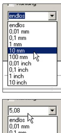
WinPC-NC kann die Achsen entweder endlos fahren, d.h. fahren, solange eine Taste gedrückt bleibt. Beim Loslassen der Taste bremsst die Achse ab und bleibt ohne Schrittverluste stehen.
