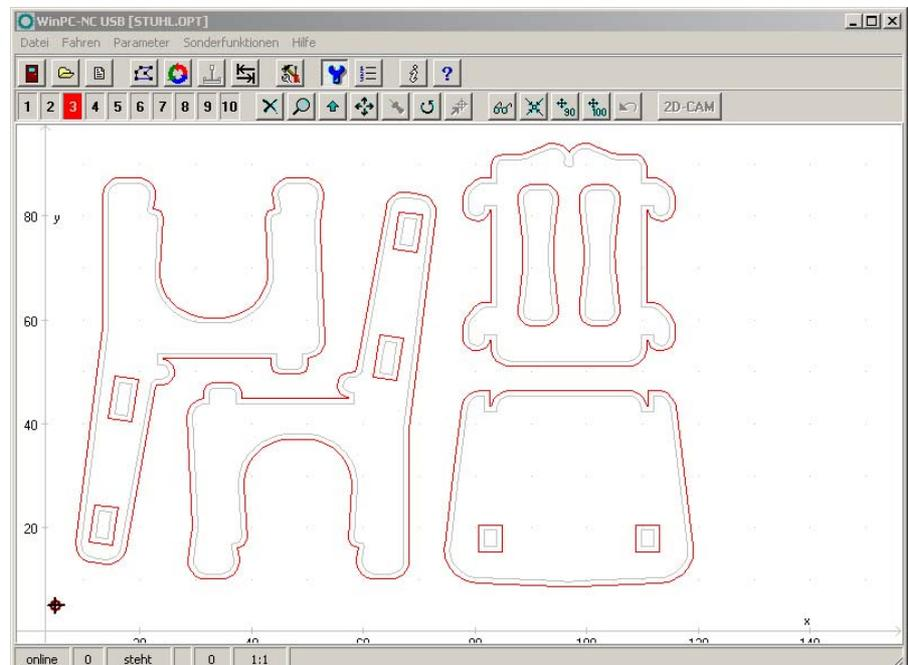
5. Nun stimmt aber die Verschiebung der neu berechneten Bahn der inneren Konturen nicht und es wurden alle gefundenen Konturen nach außen korrigiert. Wir setzen jetzt noch den Schalter zum automatischen Auffinden umschlossener Konturen und lassen die Berechnung eine letztes Mal durchlaufen.
