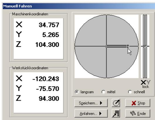
Softstick – Fahren mit fixierter Y-Achse (Lock-Y)
