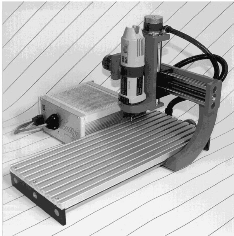
Beispiel einer 3-Achs-Fräsanlage
