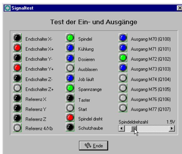
Sonderfunktion SIGNALTEST mit LED-Anzeigen der wichtigsten Eingänge
