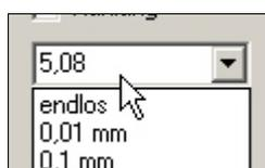
In der Funktion MANUELL FAHREN lassen sich alle Achsen entweder endlos verfahren, d.h. bis zum Loslassen der Maustaste oder Cursortaste oder diskrete Wege, die per Dropdown-Menü ausgewählt werden. Um nicht versehentlich einen vorgegebenen Weg zu starten, wenn man eigentlich endlos fahren will, kann man die Endlos-Stellung automatisch nach jeder Bewegung wiederherstellen lassen.
