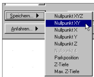
Während dem manuellen Fahren können bestimmte Hilfspunkte angefahren und abgespeichert werden. Nach Erreichen einer Position kann man leicht über das Speichern-Menü den gewünschten Punkt auswählen und dauerhaft als Parameter sichern.
