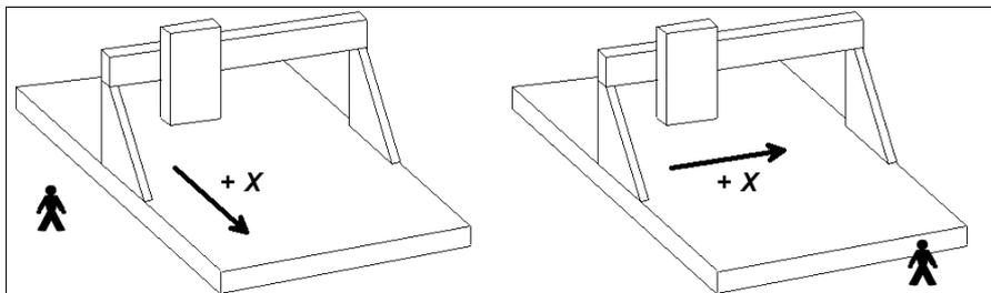
Die Pfeiltasten nach links sollten die Maschine genau in Gegenrichtung nach links bewegen.
