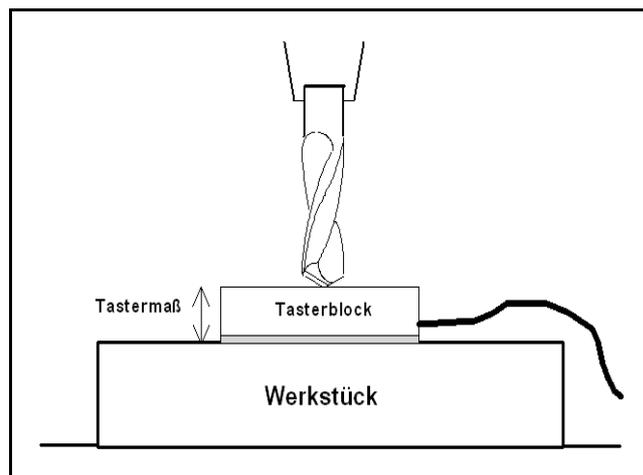
Automatische Vermessung des Z-Nullpunkts
