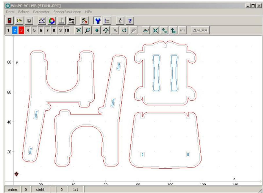
4. Wenn wir die Teile aber nur mit einem Werkzeug fräsen und keinen Werkzeugwechsel durchführen wollen, dann lassen wir die Berechnung erneut ausführen. Wir setzen die Funktion zurück, ändern bei der Werkzeugzuordnung die alten Werkzeuge 2+3 in das neue Werkzeug 3 und lassen alle Konturen mit dem Radius 1mm neu berechnen.
