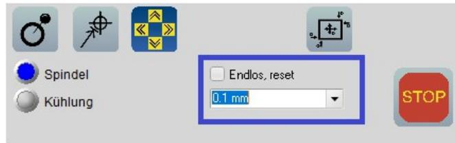
6. Wenn das Papier durch den Fräser fest geklemmt ist, sollte die Z-Achse mit dem Button **Z-** zur Sicherheit wieder freigefahren werden, bis das Blatt wieder lose ist.
