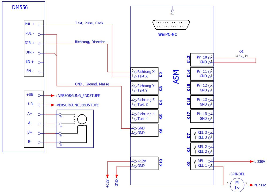
Der Schaltplan zeigt den Anschluss für 1 Endstufe
