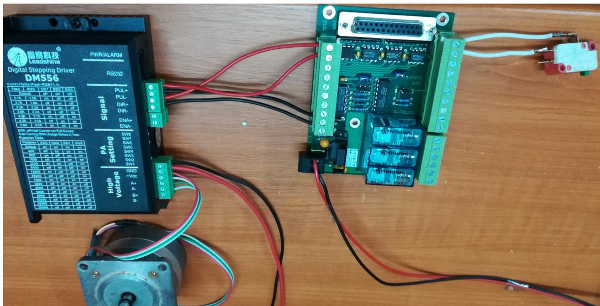
Im Bild ist die Verkabelung zur Ansteuerung einer Leadshine DM556 und eines Schalteinganges zu sehen.
