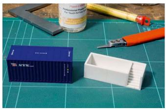
Die gefrästen Teile des Swimmingpools werden mit feinem Schleifpapier gesäubert und so für den Zusammenbau vorbereitet.
