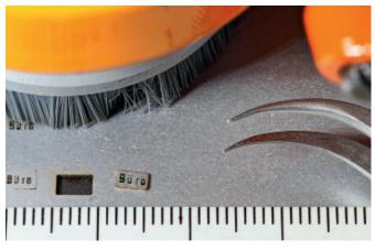
Der Sichtzaun hat eine Größe von 23 x 23 mm und ein Blick gegen das Licht zeigt, dass die vorgesehenen Ausschnitte perfekt mit dem Lasergerät (0,1 mm Durchmesser) geschnitten wurden.
