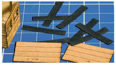
Als nächstes Projekt stand ein kleines Gartenhaus auf dem Plan, bei dem die Holzbretter graviert werden sollten. Die Fenster und die Außenkonturen sollten dann ausgeschnitten werden. Dafür wurde die Zeichnung wieder auf verschiedenen Ebenen ausgeführt um dann die einzelnen Arbeitsschritte durchzuführen.
