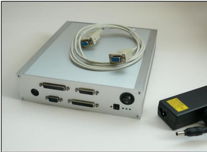
Je nach Kundenanforderung bieten wir für jede Anwendung verschiedene Varianten und Erweiterungen unseres Achscontrollers. Es können zB. digitale Ein-/Ausgänge mit 24Volt-Logik nachgerüstet werden oder 0-10 Volt Analogausgänge für die Drehzahl- und Leistungssteuerung. Auch viele Sicherheitsfunktionen wie Schutzhaube, Füllstände, Druckluft, Positionen und externe Komponenten werden permanent überwacht und mit definierbaren Warnmeldung versehen.
